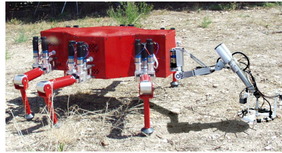
Figura 8. Silo 6, robot caminante hexápodo para la detección de minas antipersona (CSIC).
