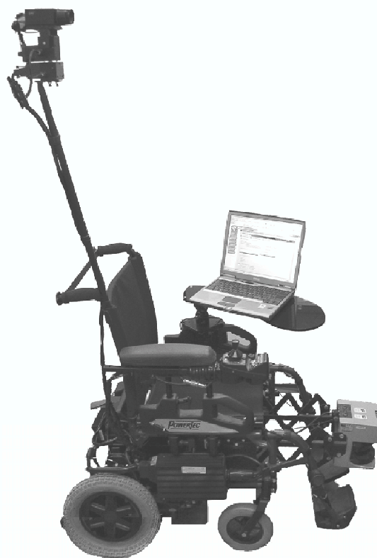
Figura 1. La silla eléctrica de navegación autónoma SENA.
