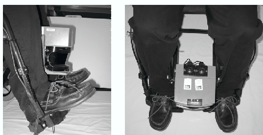
Figura 3. El escáner láser radial proporciona información precisa del entorno que es empleada para la evitación de obstáculos y localización de SENA.
