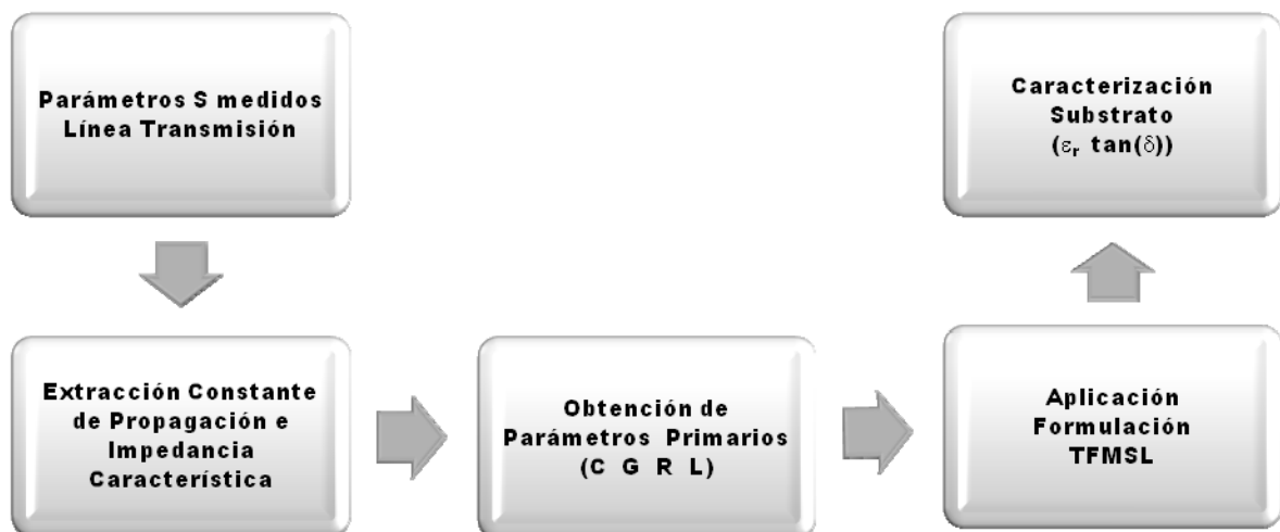
Fig.5. Algoritmo del método utilizado para obtener las propiedades dieléctricas del sustrato.
