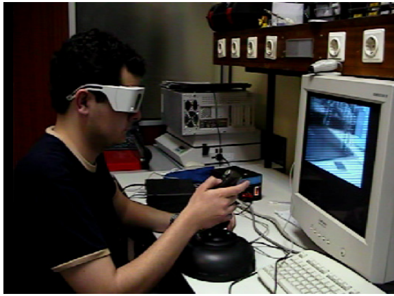
Figura 8. Teleoperación del sistema RobMAT. El operador está guiando una molécula, para ello genera órdenes de movimiento con un joystick mientras visualiza imágenes estereoscópicas.
