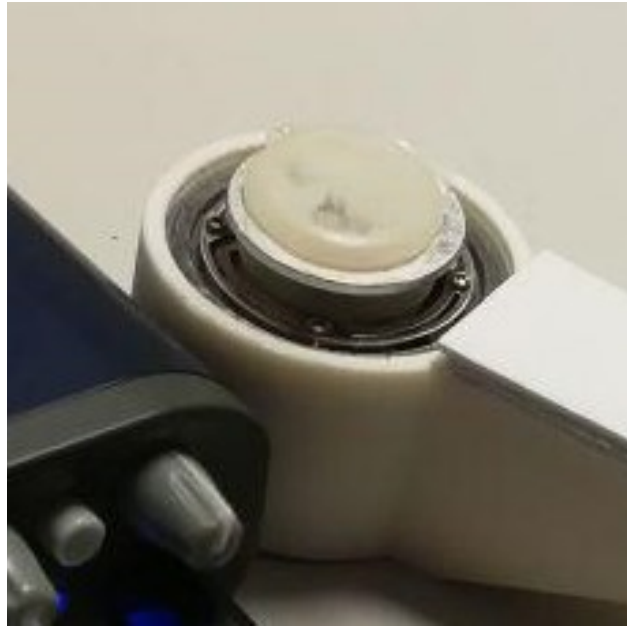
Ilustración 23. Transductor con carga de material termofusible
