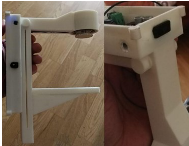
Ilustración 15. Vista del conector CC y la entrada Jack 3.5
