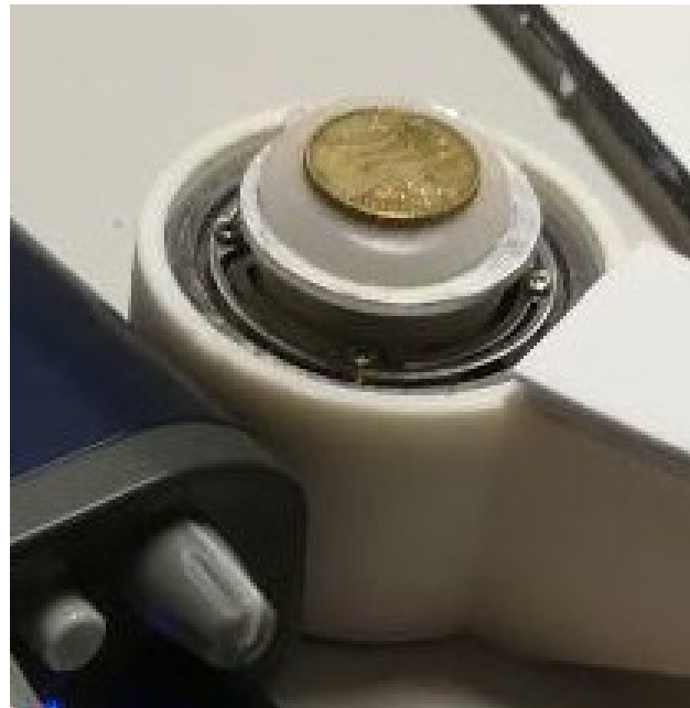
Ilustración 26. Transductor con carga de material termofusible y una segunda carga
