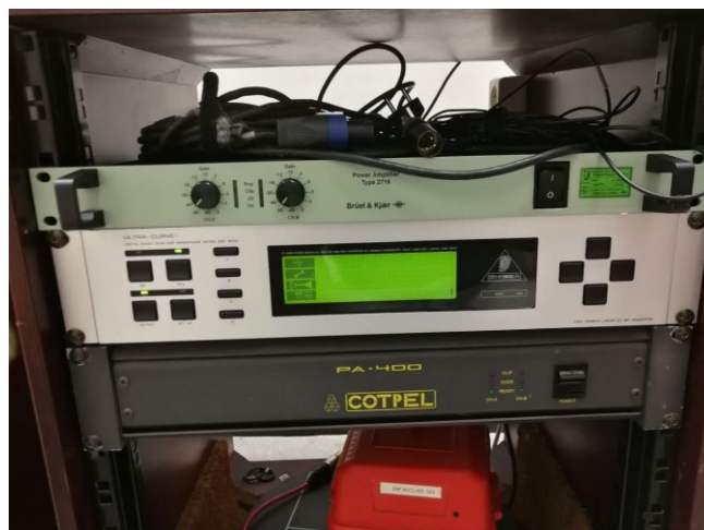
Ilustración 33. Generador de ruido rosa en el centro externo a la cámara anecoica
