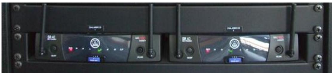
Ilustración 58 Conjunto Microfónico Inalámbrico. Fuente: [www.cfp.upv.es](http://www.cfp.upv.es). Fotos: Elaboración propia
