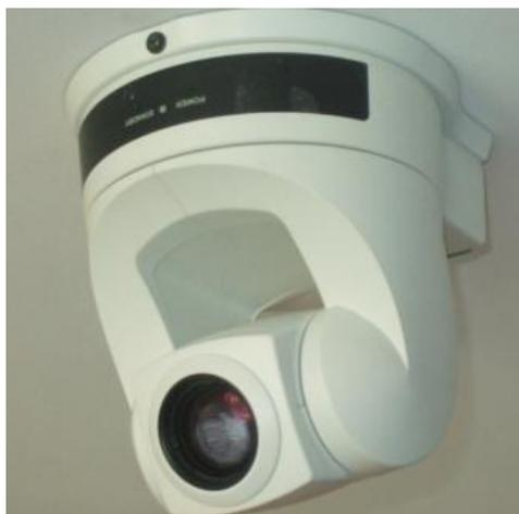
**Ilustración 66** Cámara de giro/inclinación/zoom y Mando a Distancia Fuente: [www.cfp.upv.es](http://www.cfp.upv.es). Fotos: Elaboración propia
