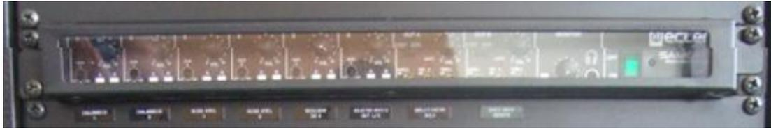
Ilustración 59 Mezclador de Voz. Fuente: [www.cfp.upv.es](http://www.cfp.upv.es). Fotos: Elaboración propia
