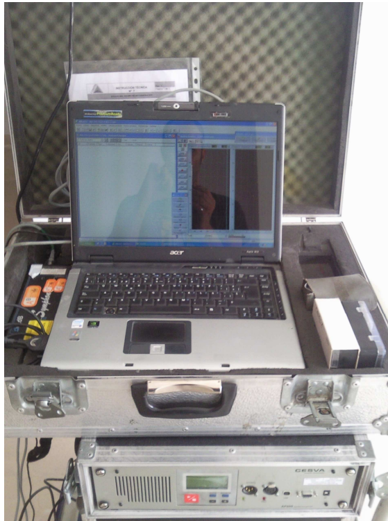
Ordenador portátil con software dBati32 y sonómetro Symphonie
