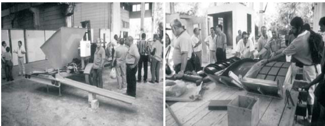
Figura 2. Máquina de bloques de suelo cemento (derecha). Semibóveda de cerámica armada (izquierda). Tecnologías Para Viviendas de Producción Social en América Latina. Universitat Politècnica de Catalunya. Lorenzo Gállego Pedro.
