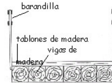
Figura 19. Sección transversal tipo. Ingrid Raventós (2000).
