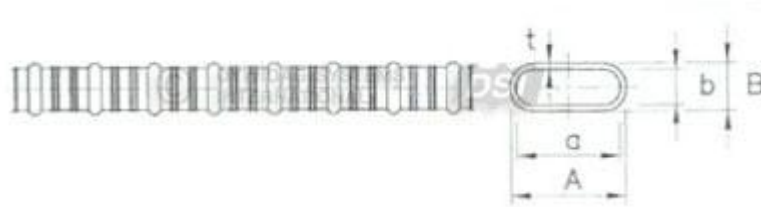
FIG 83 Dimensiones vaina PE/PP
