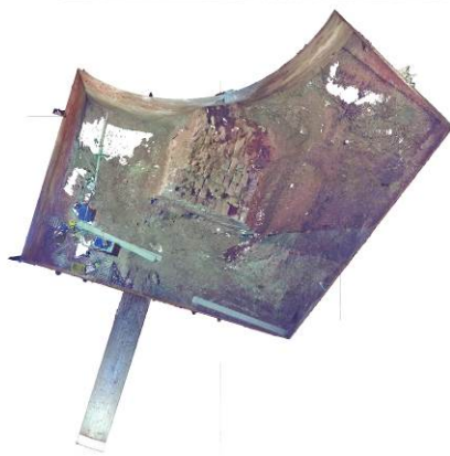
Fig. 15. A sinistra, ortofoto da rilievo laser scanner 3D del vano interno al bastione. A destra, modello 3D da nuvola di punti del volume interno. In evidenza la conformazione plano-volumetrica (Mitello & Muscatello, 2014).
