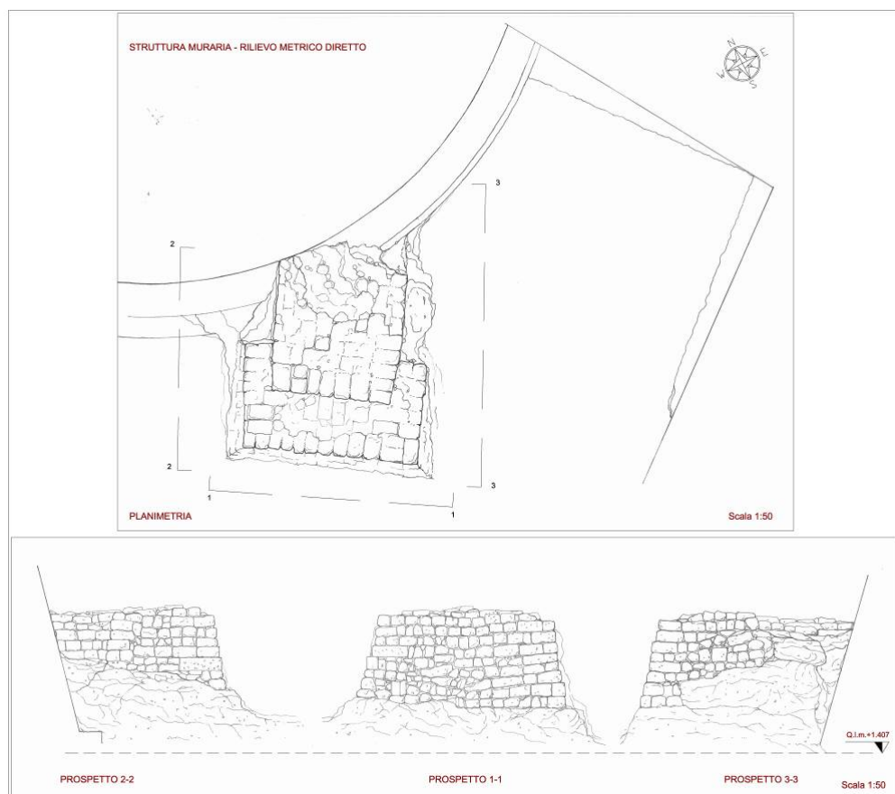
Fig. 12. Rilievo metrico diretto della struttura muraria addossata alla rondella quattrocentesca con caratterizzazione degli elementi costitutivi (elaborazione grafica G. Muscatello, 2014).
