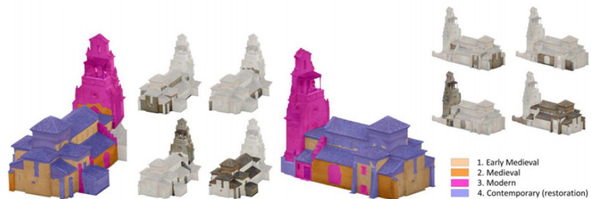
Figura 37. Modelo 3D con base de datos semántica. Visualización de la evolución constructiva de la iglesia de San Cebrián de Mazote (España) (Fuente: Utrero et al. , 2016)
