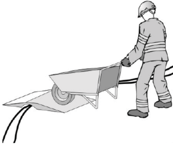
Protección de conductores.
