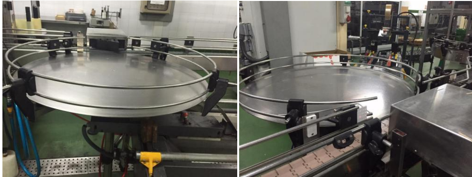
Figura 71 Almacén provisional botellas defectuosas
