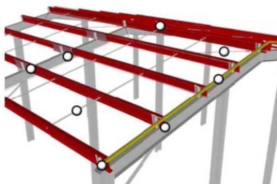
Ilustración 21. Correas de Cubierta.
