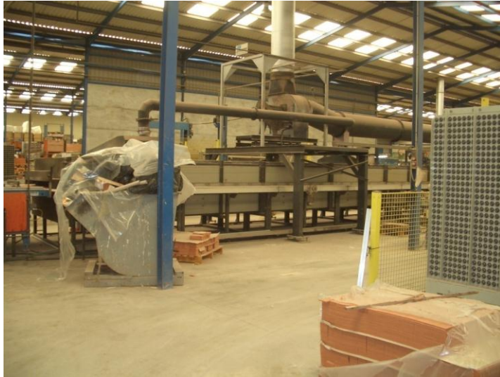
Figura 49.- Horno monoestrato industria cerámica. Miura Cerámicas S.L.
