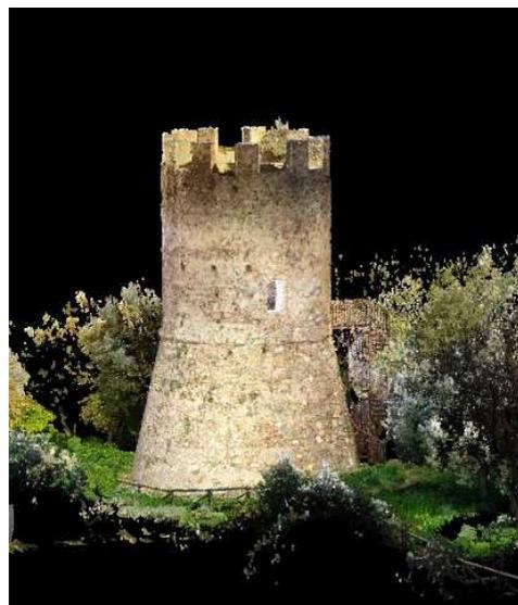
Fig. 3. Restituzione nuvola di punti della Torre Le Pietre Nere (Palmi-Reggio Calabria). Rilevamento effettuato con Laser Scanner FARO.
