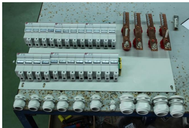
Figura 2.20. Cuadro unificación 6 inverters. Sin montar, falta la envolvente. Foto tomada en instalaciones de Togar
