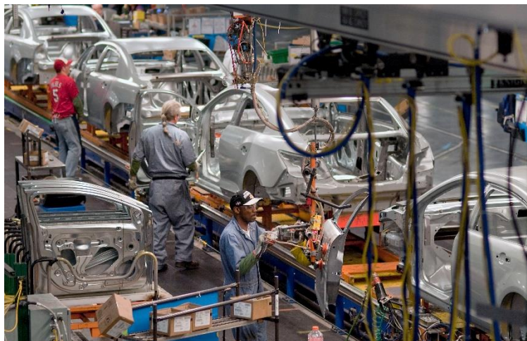
Imagen 2. Línea de ensamblaje en Ford. Los operarios siempre están en la misma posición y son los vehículos los que están en movimiento mediante una cinta transportadora. (Imagen extraída de Alvolante info, 2016.)
