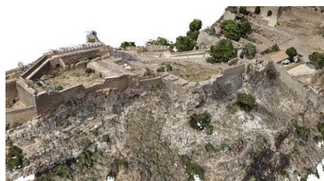
Fig. 6. Nube de puntos densa del conjunto de lienzos.
