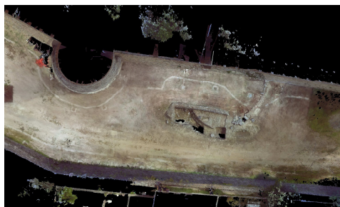
Fig. 8. Ortofoto da rilievo laser scanner 3D a colori della Torre della Duchesca (a sinistra) e del basamento della Torre demolita (a destra). In evidenza la differente conformazione planimetrica delle due torri (Mitello & Muscatello, 2018).
