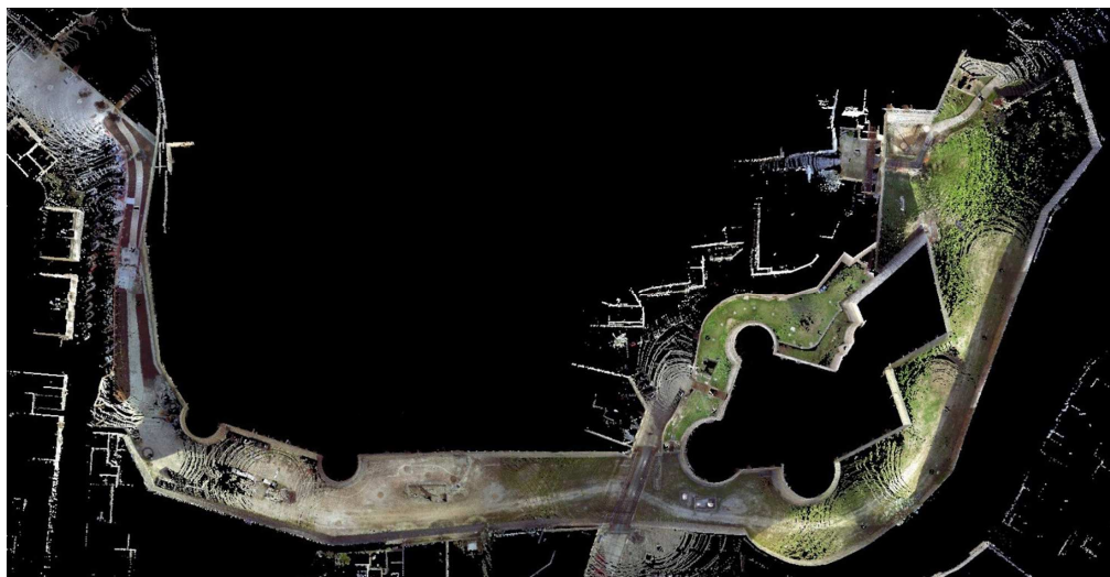
Fig. 3. Otranto. Rilievo laser scanner 3D. Vista dall'alto dei fossati che corrono lungo il perimetro del nucleo storico della città e del castello aragonese. In evidenza le torri e l'andamento del muro di controscarpa (Mitello & Muscatello, 2018).
