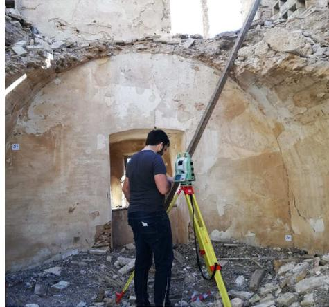
Fig. 3. Toma de datos con la multiestación en el interior de la primera planta de la Torre (Autores).
