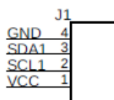
Figura 24. Conector 4 pines para el display SSH1106. Fuente: elaboración propia.
