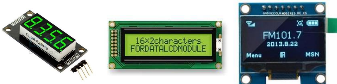
Figura 8. Displays estudiados TM1637, FDCC1602B y SSH1106 de izquierda a derecha: Fuente: TM1637, FDCC1602B y SSH1106 Datasheets.
