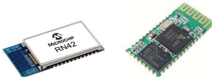
Figura 9. Módulos Bluetooth, RN-42 (izq.) y HC-05 (dcha.): Fuente: RN-42 y HC-05 Datasheets.
