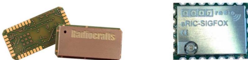
Figura 4. Ejemplo de dos módulos SigFox. RC1682 (izq.) y eRIC-SIGFOX (dcha.). Fuente: Datasheet RC1682 y eRIC-SIGFOX
