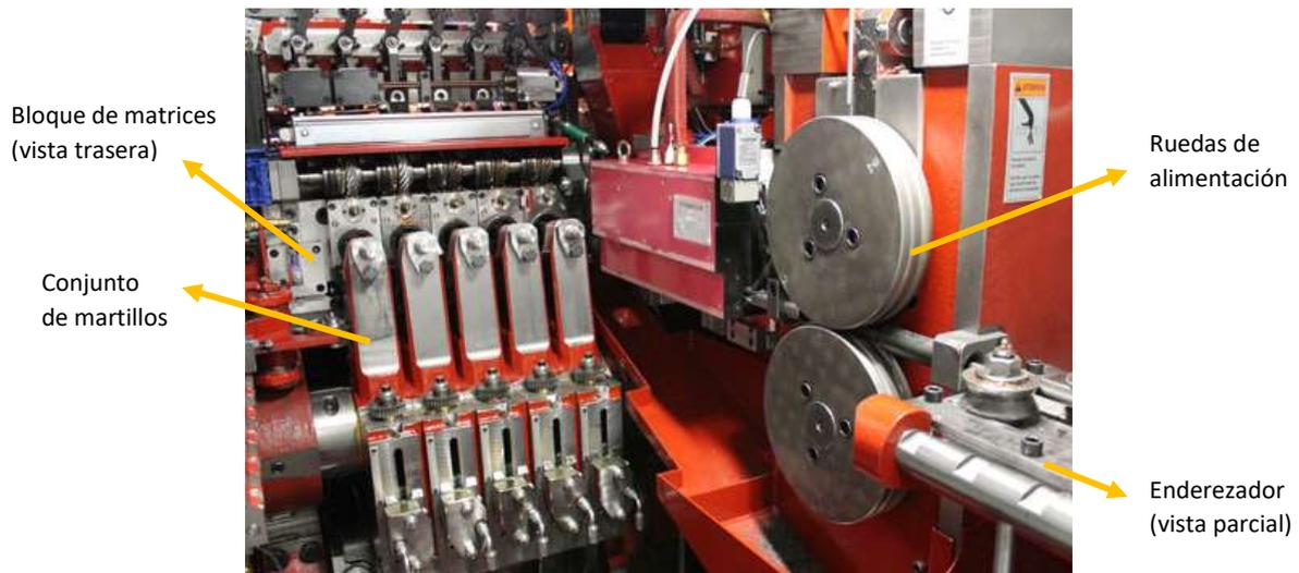
*Figura 8 Vista del ingreso del material a la prensa*
