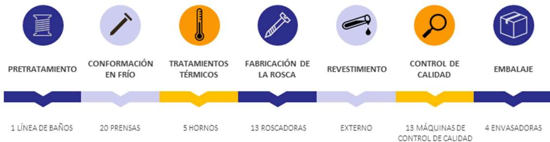
Figura 6 Etapas de fabricación y maquinaria disponible en planta de Valencia
