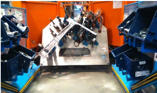
Figura 13: Ejemplo de utillaje y cinta de salida de la pieza final de la línea 7J V408. (Fuente: Fotografía proporcionada por la empresa.)
