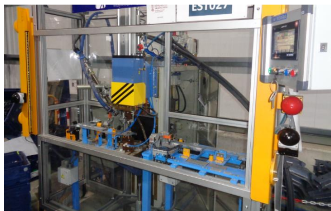
Figura 14: Ejemplo estática de soldadura manual (Fuente: Fotografía proporcionada por la empresa)
