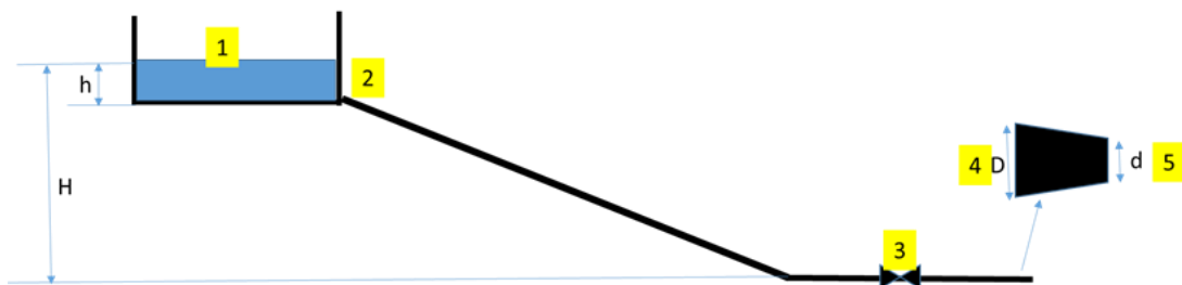
Figure 20. Schéma simplifié d'une STEP.
