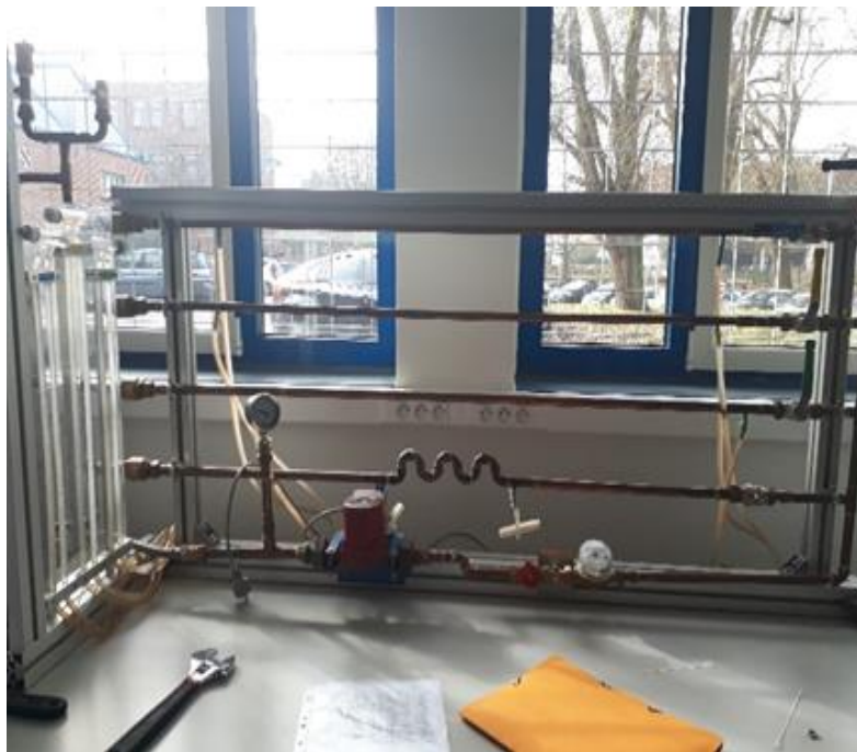
Figure 40. Dispositif expérimental pour étude de pertes de charge linéaires.
