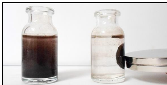
Figura 12. Acción de las nanopartículas magnéticas sufriendo una interacción con el campo magnético.
