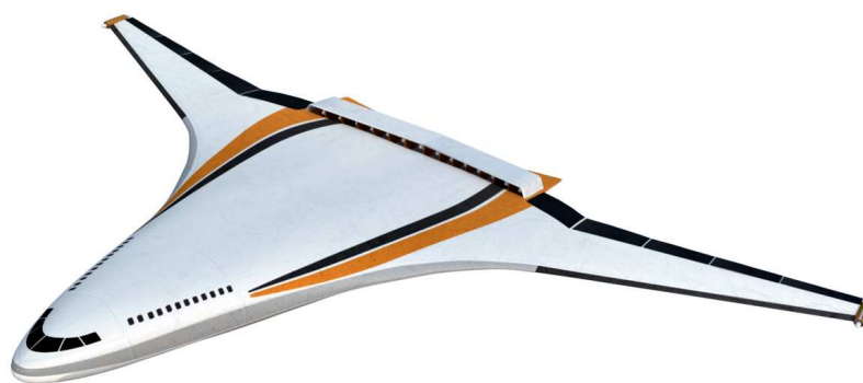
Figura 2.1: Concepto N3-X con propulsión distribuida (Felder y cols. (2009))
