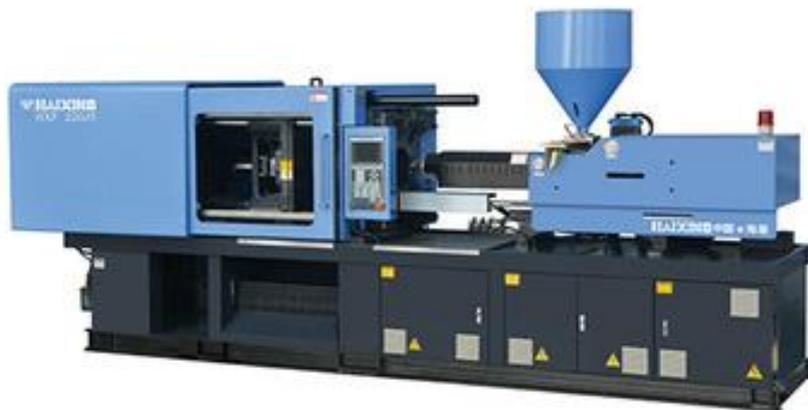
El moldeo por inyección de plástico consiste en la fundición de gránulos de plástico, en este caso ABS, que cuando se funden lo suficiente se inyectan a presión en la cavidad de un molde que queda relleno y solidificado para crear el producto.
