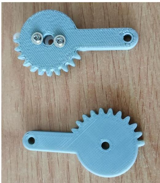
Ilustración 71: Engranajes del Gripper Impresión 3D
