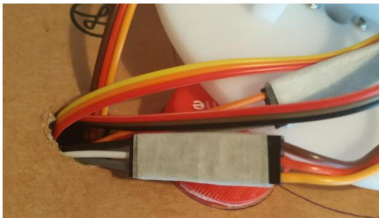
Ilustración 96: Detalle de la unión entre cables Dupont
