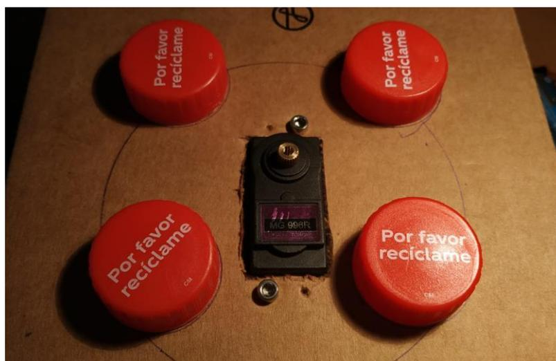
Ilustración 88: Montaje del Servomotor 1 y las guías-soporte de la Base giratoria
