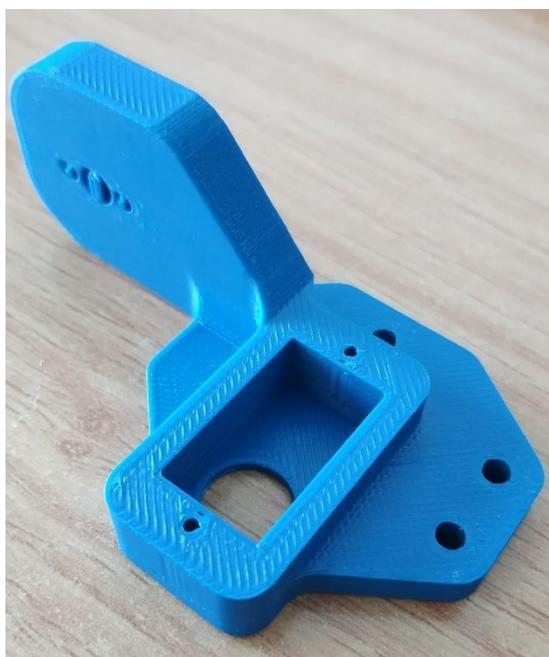
Ilustración 73: Base del Gripper Impresión 3D
