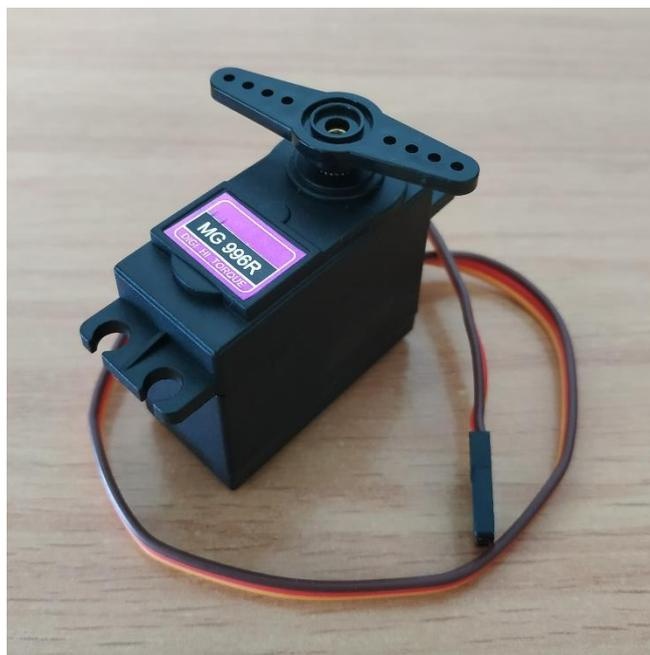
Ilustración 75: Servomotor MG996R
