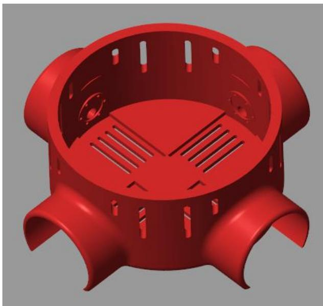
*Ilustración 14: Chasis plataforma omnidireccional*
