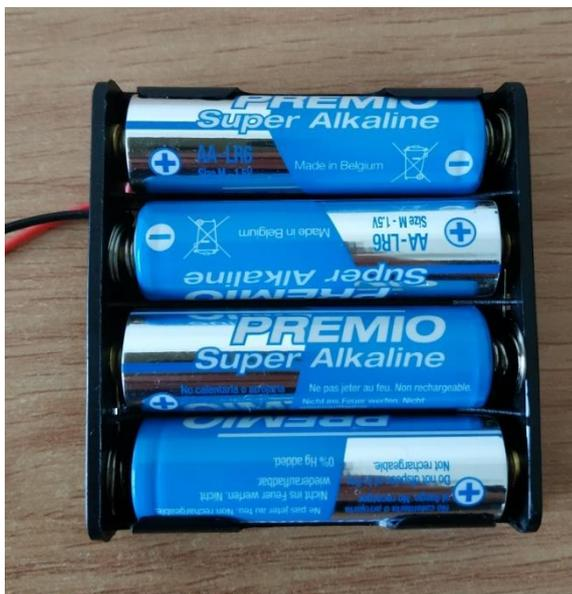
Ilustración 78: Fuente de alimentación 6 V y 8000 mAh
