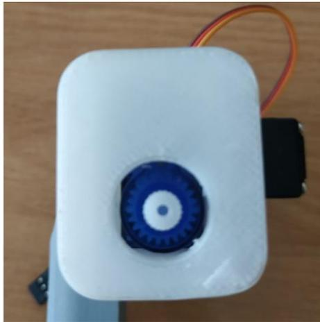
*Ilustración 91: Detalle del servo alojado en
