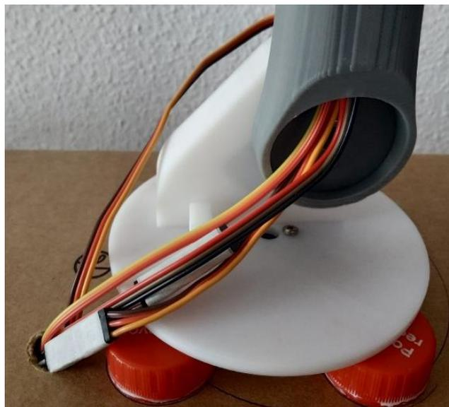
*Ilustración 98: Detalle del agrupamiento de cables y su inserción en la caja soporte*
