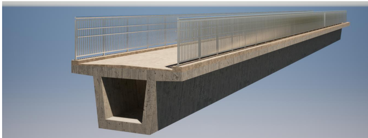
Fig. 19 Vista pasarela sección cajón.
