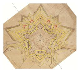
Fig. 3. Anonymous, Projet General pour l'Achevement des fortifications de la Ville et Citadelle de Turin, detail, 100 trabucchi=102 mm (1300 x 857 mm). Graphical analysis and geometric construction superimposed on the original plate. (Archivio di Stato, Carte Topografiche e disegni, Ufficio generale delle finanze, Tipi Sezione II Ufficio generale delle finanze, Torino fortificazioni, mazzo 356. Reconstructive drawing: R. Spallone).
