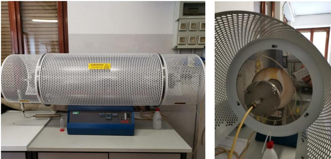
Figura 8. Horno de vacío Lenton YL3216 CC.
