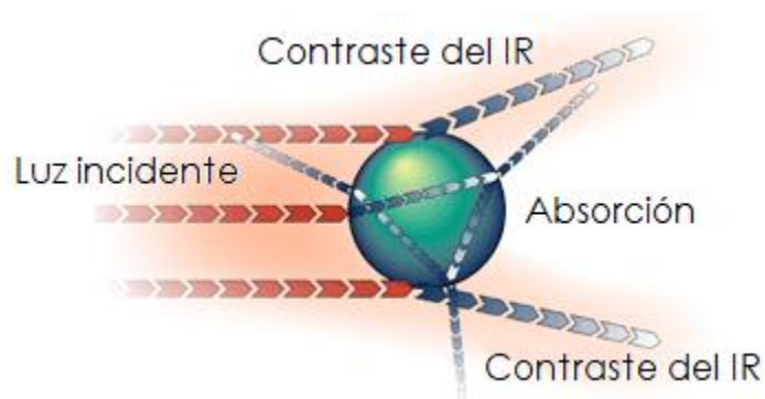
Figura 3.14 Predicción de luz dispersada por el modelo Mie para medición de tamaño de partícula.
