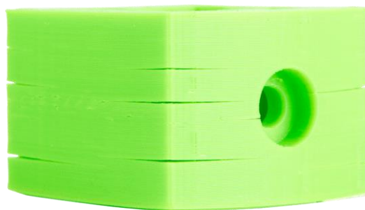
Figura 6: Ejemplo de efecto “cracking”. Se ha producido un cambio de temperatura brusco entre capas provocando una separación de éstas. [15]
