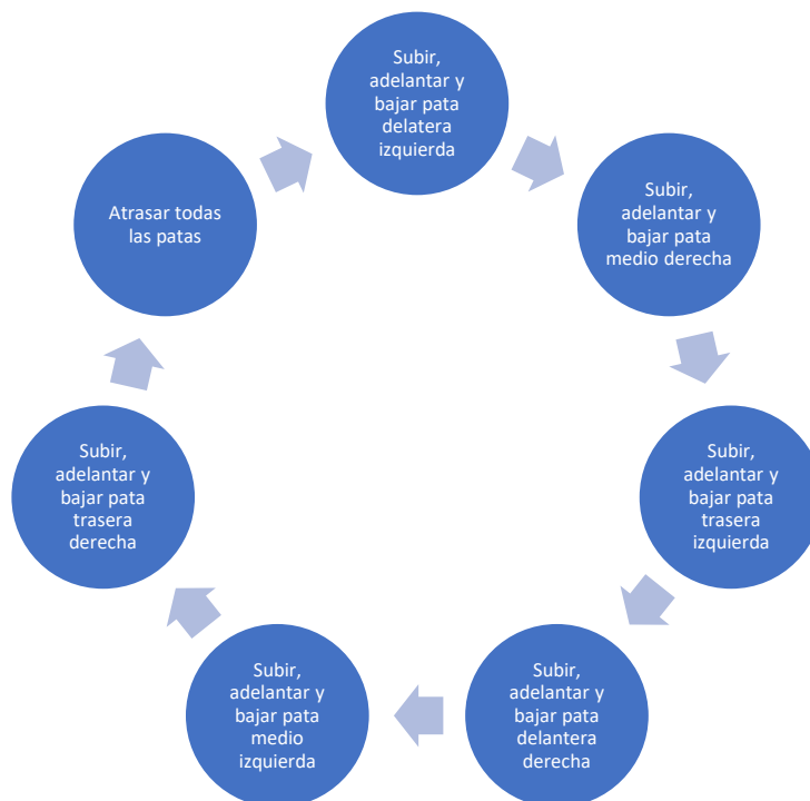
Figura 20: Ciclo realizado por las patas del robot hexápodo para moverse hacia adelante.
