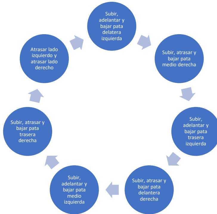
Figura 21: Ciclo realizado por las patas del robot hexápodo para girar hacia la derecha.
