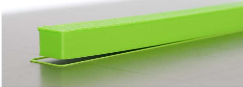
Figura 5: Ejemplo de efecto “warping”. La base se ha despegado de la cama caliente, deformando así la pieza. [14]
