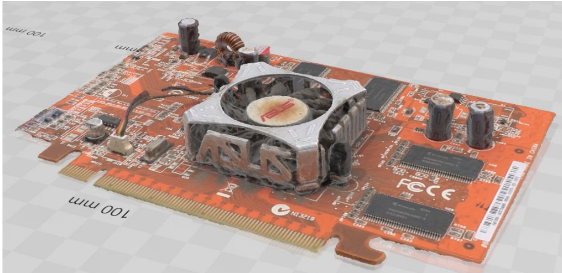
Imagen 48: Resultado del escaneado 3D de la placa GPU.
