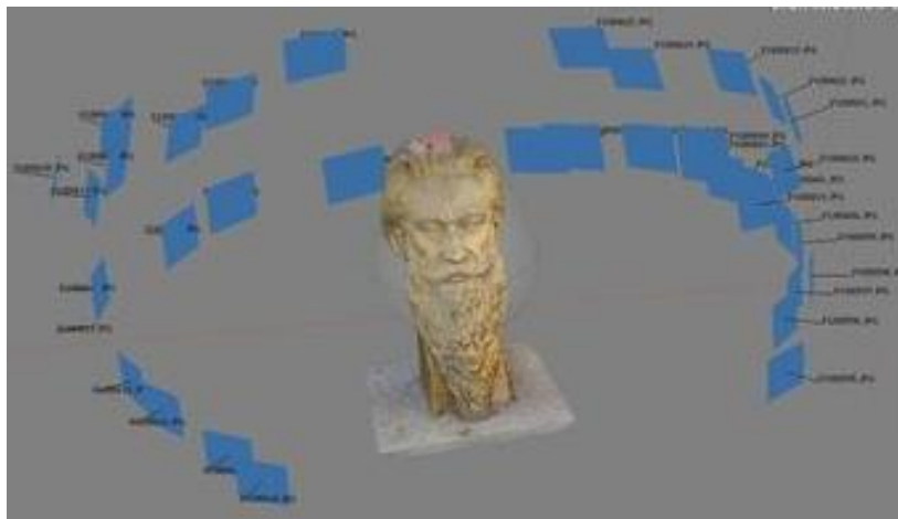
Imagen 2: Ejemplo de modelo obtenido mediante fotogrametría. (Imagen obtenida de Referenci 2)
