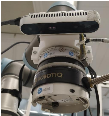
Imagen 37: Unión de la cámara con el brazo robot.
