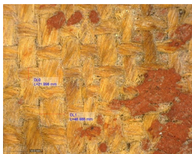
Imagen 47. Macrofotografía para la medición del grosor del hilo. Realizada con Dinolite a 1X.
