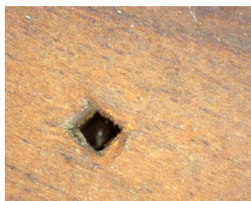
Imagen 68. Macrofotografía del orificio resultante de los clavos. Realizada con Dinolite a 50X
