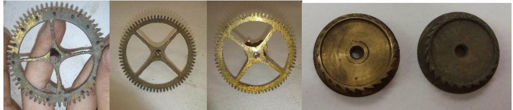
Figura 23. Detalles comparativos del antes y el después de diferentes piezas de la maquinaria durante la limpieza
