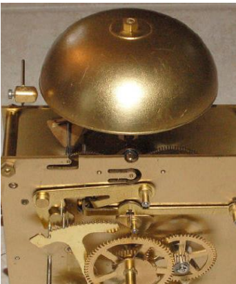
Figura 6. Sistema de sonería del reloj, martillo y campana
