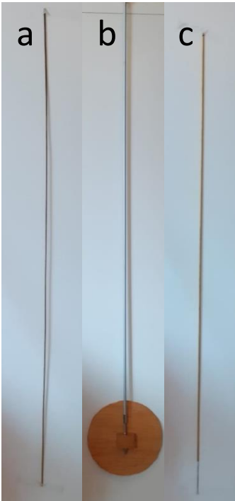
Figura 32. Los materiales que se tuvieron en cuenta. a) torcida, susceptible a la deformación, b) excesivamente ancho, c) opción final varilla roscada de 3mm reforzada con una cánula de 4mm
