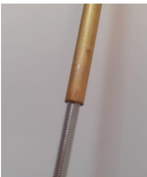
Figura 33. Detalle de la varilla roscada de 3mm en el interior de la cánula de 4mm
