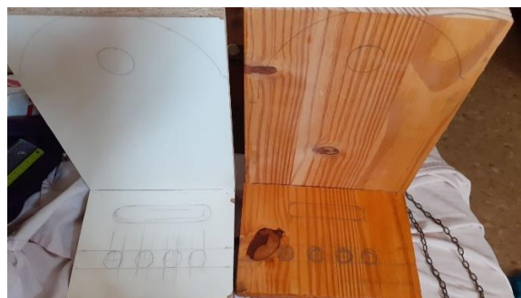
Figura 45. Realización del prototipo del soporte en dos materiales distintos, A la izquierda en madera aglomerada y a la derecha en madera maciza
