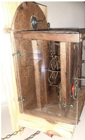
Figura 43. Tapa de plástico acoplada al armazón
