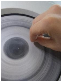
Figura 10. Lijado y pulido de las muestras con una lija eléctrica.
