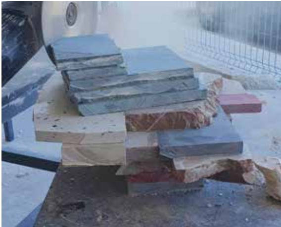
Figura 21. Resultado del encolado. Bloque inferior.
