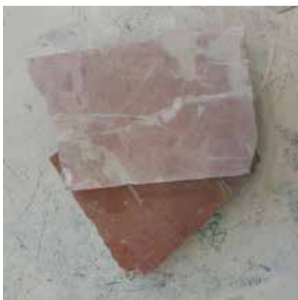
Figura 11. Resultado del proceso de pulido mediante lijadora provista de abrasivos.
