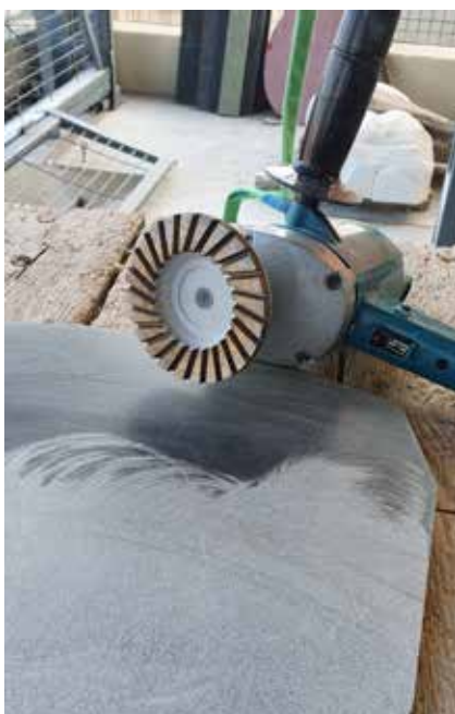
Figura 9. Proceso de pulido mediante discos de tungsteno.
