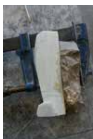
Figura 18. Presión para el encolado con gatos.
