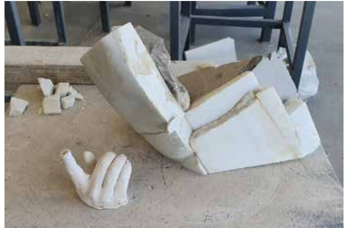
Figura 22. Resultado del encolado. Bloque superior.
