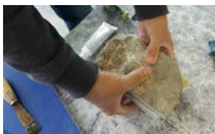
Figura 17. Presión para el encolado con las manos.
