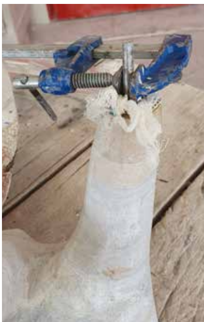
Figura 35. Proceso de pegado barra de hierro-bloque superior.
