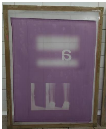
Fig. 22. Pantalla de serigrafía emulsionada con diseño propio. Fotografía propia.
