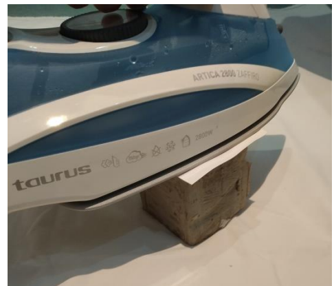
Imagen impresa encarada al cemento para, con el efecto de la resina termo-sensible, realiza la transferencia con el calor de la plancha.
