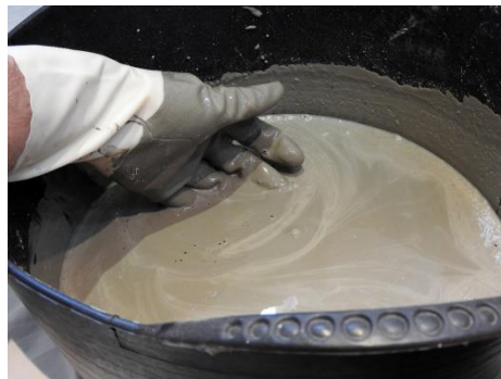
Mezcla del cemento en polvo con agua y depósito en los moldes para el fragado.
