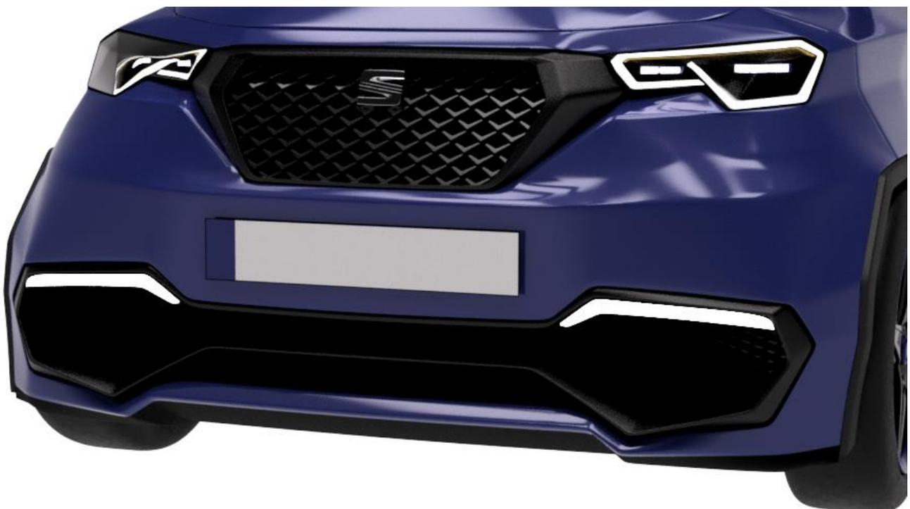
Para reducir las bajas presiones de la zona anterior de la rueda delantera (en el pase de rueda) se direcciona el aire a través de la zona lateral de la rejilla inferior, con esto se consigue atenuar las depresiones producidas en esta zona consiguiendo menor resistencia aerodinámica o también puede redireccionarse para la ventilación de los discos de freno, aunque dado el peso y el uso de este vehículo no sería necesario.
