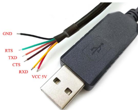
Figura 2.26: Cable adaptador comunicación USB a UART
