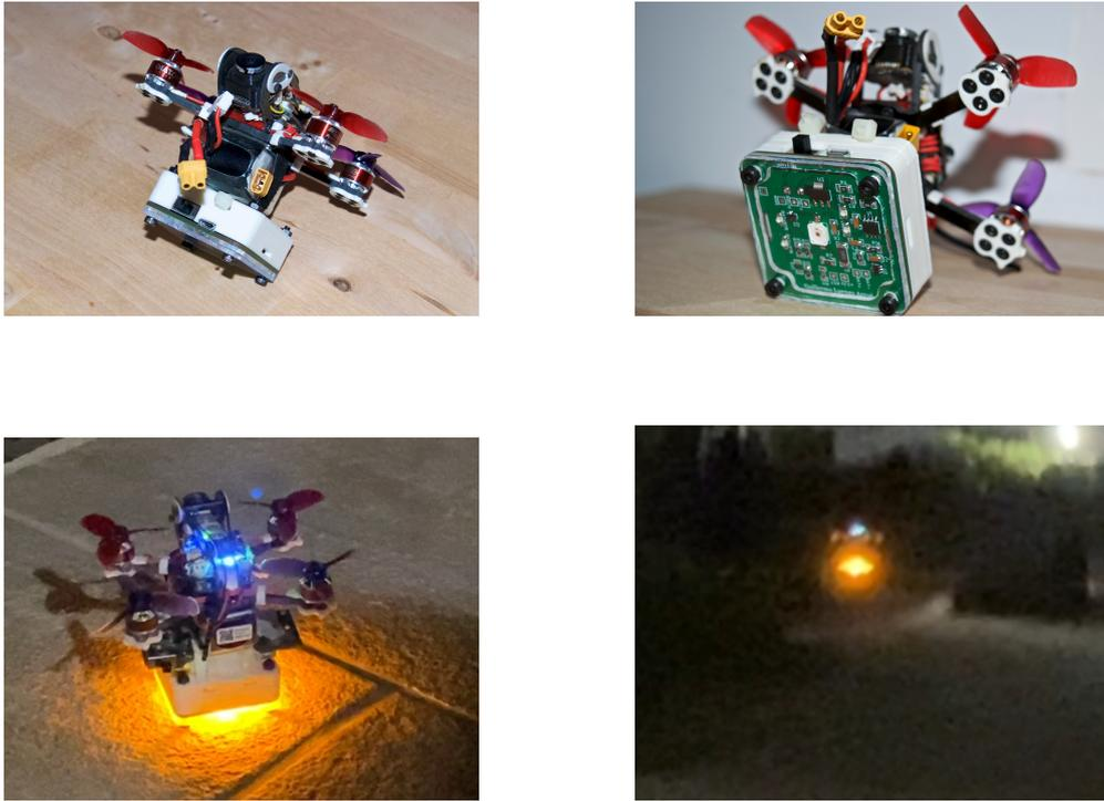
Figura 3.2: Módulo montado en drone
