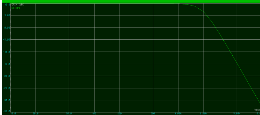
Fig. 19 – Bode FPB2 teórico: Diagrama de Bode teórico del filtro paso bajo con f_c de 2000 Hz.
