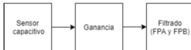
Fig. 6 – Diagrama de bloques: Diagrama de bloques compuesto por tres etapas.
