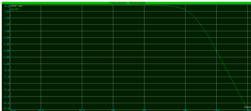
Fig. 18 – Bode FPB1 teórico: Diagrama de Bode teórico del filtro paso bajo con f_c de 600 Hz.
