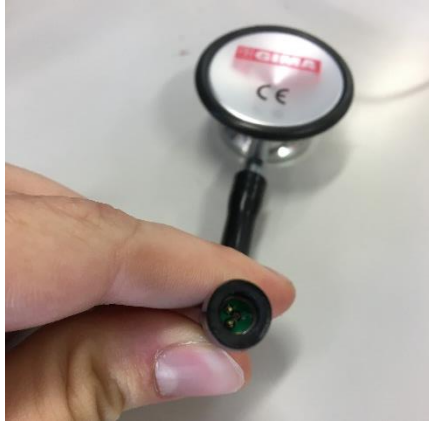
Fig. 24 - Micrófono capacitivo: Se observa la colocación del micrófono en el interior del tubo, el cual hace de conexión entre el diafragma/campana y el propio micrófono.
