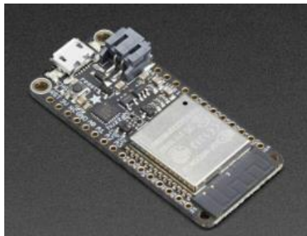
Fig. 36 – Adafruit HUZZAH32 – ESP32 Feather (New York, EE. UU.): El Adafruit Feather HUZZAH32 es una placa con conectividad Wifi-basada en el ESP32 (WROOM32). Esta placa no tiene un microcontrolador AVR, sino que utiliza el ESP32 como procesador principal [25].
