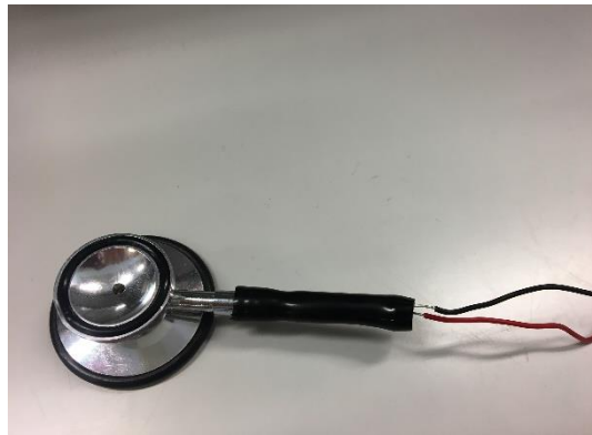
Fig. 25 - Micrófono capacitivo con soldadura a cable: Resultado después de soldar los cables de masa y alimentación al sensor.
