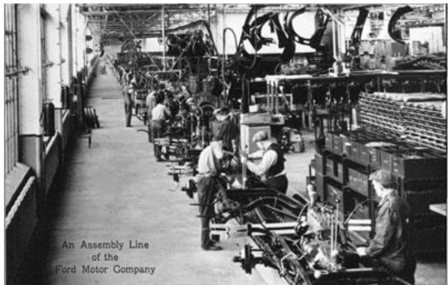
Figura 17- Ford presenta la línea de ensamblaje móvil integrada para la producción automática, 1913.
