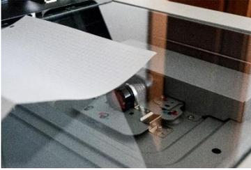
**Fig. 9.** Pantalla de exposición y dispositivo óptico (lente) del escáner de la impresora Konica Minolta bizhub C258.
