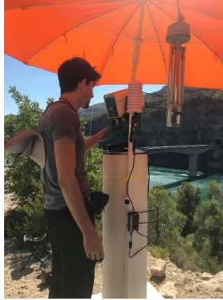
Figura 9: Vértice equipado con un parasol e instrumentos de medidas meteorológicas
