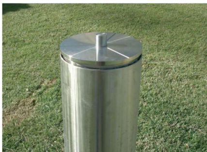
Figura 22: Perspectiva de un pilar de la base de calibración de la UPV
