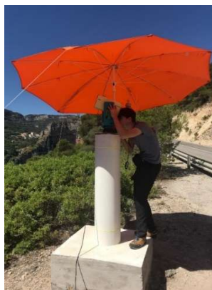
Figura 8: Medición de distancias con el Kern ME5000 Mekometer
