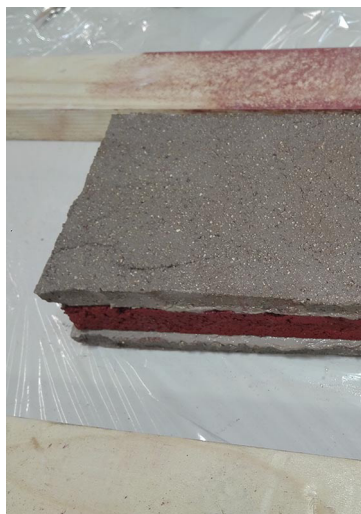
Fig. 25. Elaboració de planxa, unint Gres CH i gres CH roig. 12x23 cm.
