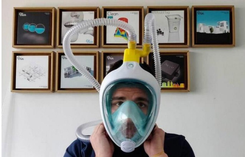
Figura 5: Máscara de buceo utilizado para los respiradores con válvula amarilla fabricada en impresora 3D.
