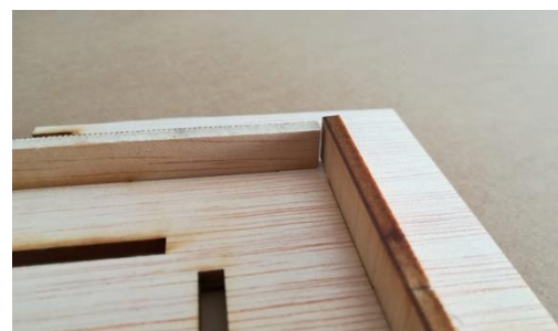
Figura 63. Topes rediseñados insertados
