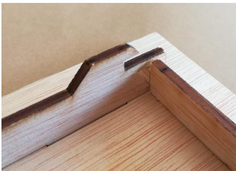
Figura 100. Variante 2. Encaje de los topes
