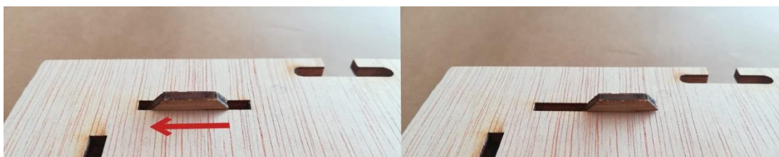
Figura 102. Variante 2. Acople y desplazamiento de la tapa
