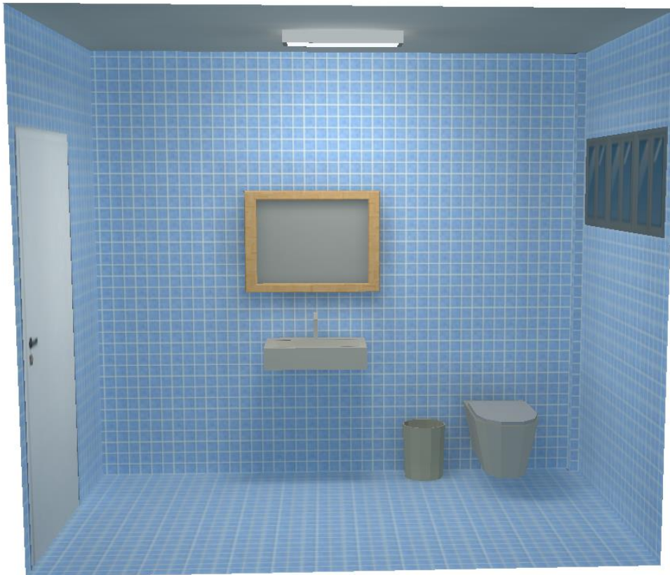
Ilustración 21 - Modelo 3D resultado del cálculo lumínico del local aseos clínica.
