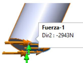
Imagen 5-21 Detalle fuerza y sujeción simulación.
