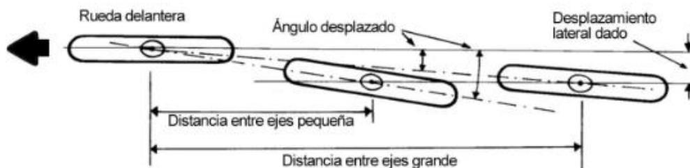
Imagen 3-25 Estabilidad direccional según distancia entre ejes.
